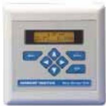
**Xmt-C 电导率变送器**可以与 ENDURANCE 电导率传感器组合。该变送器屏幕显示两行，显示所有操作和提示信息，简易的语言提示指导用户很快地进入每一步操作程序。此外，该变送器有两种可供选择的数字通讯方式：HART 通讯（选型代码-HT）和 FF 现场总线（选型代码-FF）。这两种通讯方式都可以使用 AMS 软件（设备管理程序），通过 AMS 软件，借助于个人计算机或工厂主机，操作人员可以对变送器进行设置、组态、读取过程变量和诊断仪器故障。仪器的操作键盘可以就地对变送器进行组态和标定，而 HART 375 手操器则可以遥控对变送器进行组态和标定。
