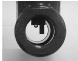
T 型三通 PN 915240-03、04 或 05 的侧视图，399 或 399VP 传感器的检测头要位于流通管线的中间位置。
